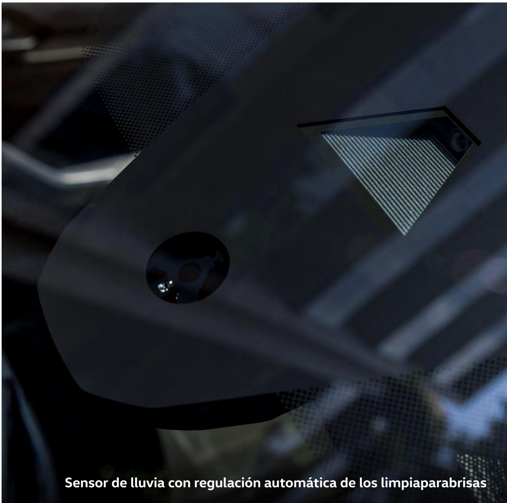
Sensor de lluvia con regulación automática de los limpiaparabrisas
