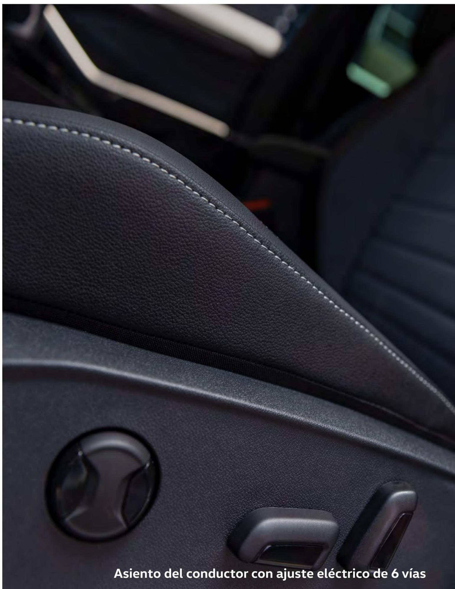
Asiento del conductor con ajuste eléctrico de 6 vías
